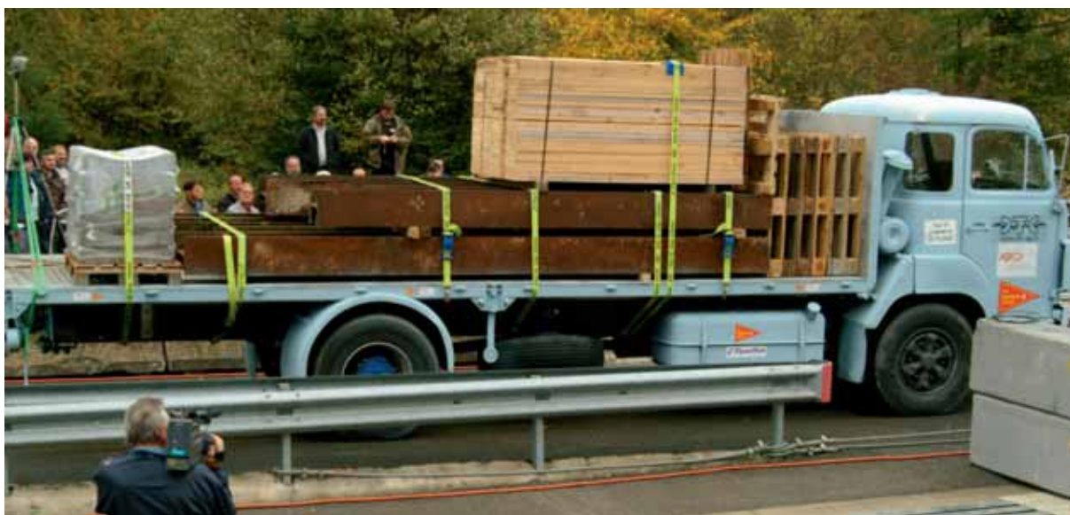
Arrimage: arrimage de sécurité renforcé avec des sangles (6 t/50 km/h)
